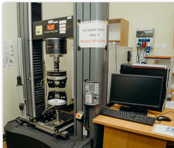
Maszyna wytrzymałościowa o maksymalnej obciążalności do 250 kN (INSTRON 3119-410)
