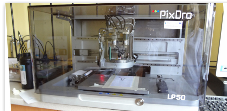
Drukarka atramentowa PiXDRO LP50 o potencjalnym zastosowaniu w tekstronice
