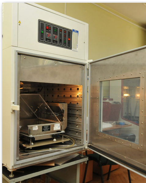
Model ludzkiej skóry w komorze klimatyzowanej umożliwiający pomiar oporu cieplnego oraz oporu pary wodnej dla tekstyliów odzieżowych
