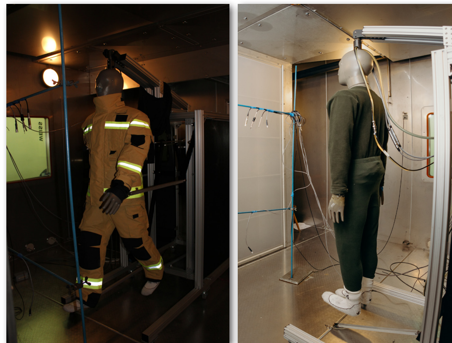
Manekin termiczny Newton w wysokogabarytowej komorze klimatyzowanej umożliwiający ocenę termoizolacyjności odzieży w różnych warunkach atmosferycznych
