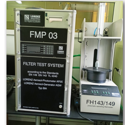
Aparat do badania właściwości filtracyjnych metoda mgły olejowej LORENZ FMP 03
